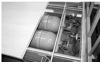
荷を積むターレットの後部には天然ガスボンベが載せられている
